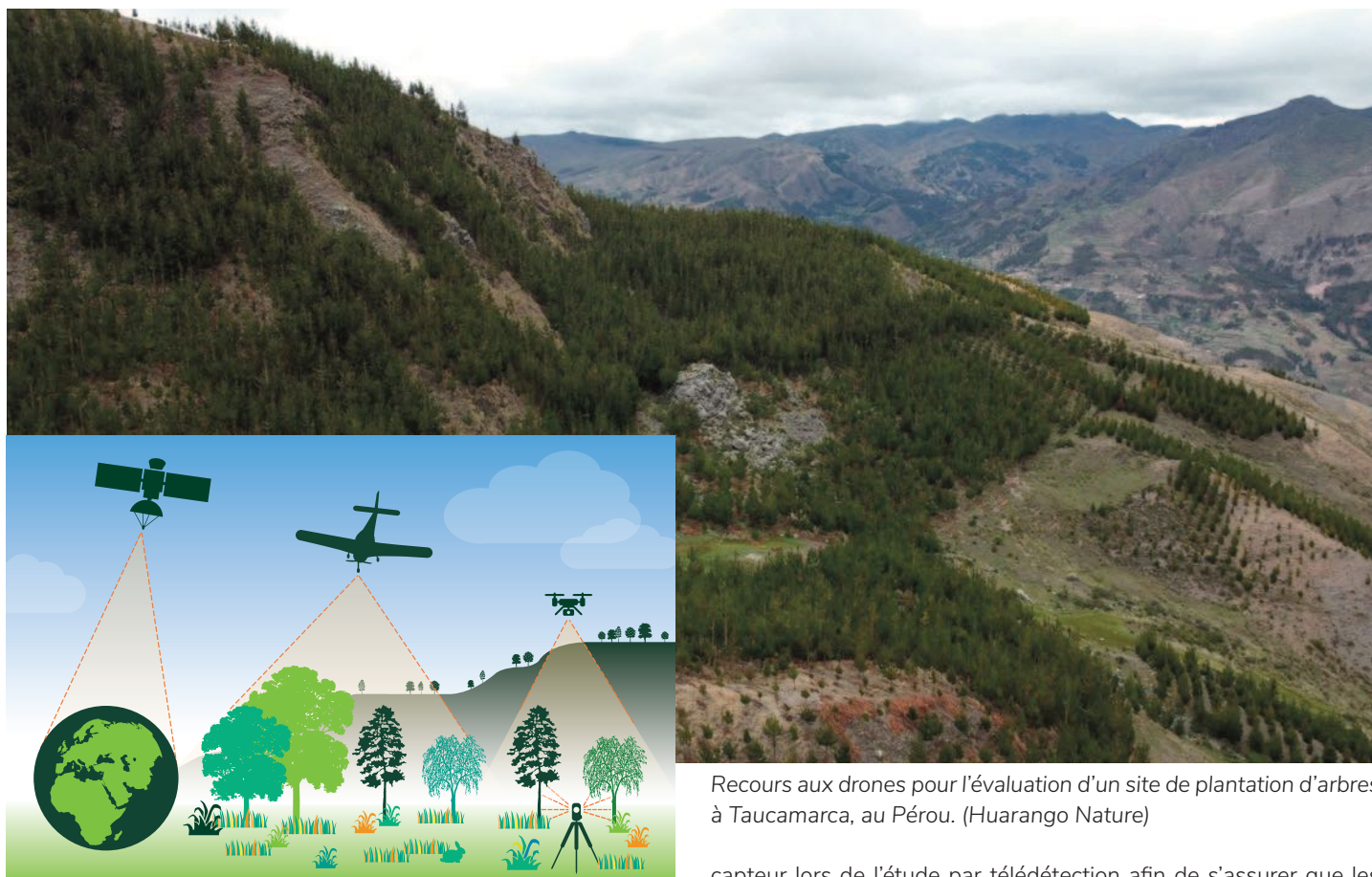
Figure 4.1 - Les données obtenues par télédétection peuvent être collectées à des échelles différentes, les capteurs pouvant être attachés à des satellites en orbite, des objets aéroportés (avions ou drones) ou installés au sol. The Global Biodiversity Standard a recours à un large panel de données issues de télédétection afin de comprendre l'état de l'intégrité écosystémique d'un site.
